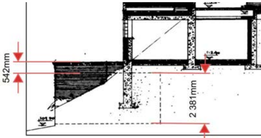
Kuva 6: Autosuojan katon paksuus leikkauskuvasta.
